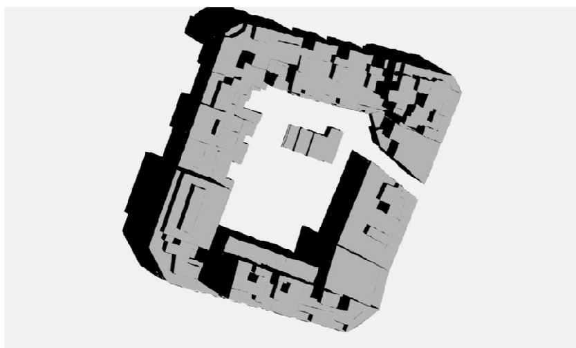
Projecció d'ombres el 21/06/2013 a les 12h a.m. Elevació: 60,49° Azimut: 120,22°
